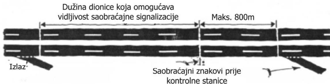
**Crtež 254: Minimalna udaljenost za postavljanje saobraćajnih znakova na putu sa više saobraćajnih traka**
